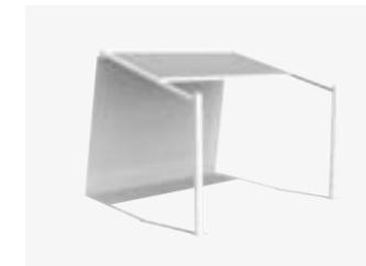
Mit Dachauskragung (mit „versetztem“ Pfosten)
